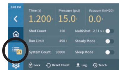
Wskazanie numeru programu na ekranie głównym
