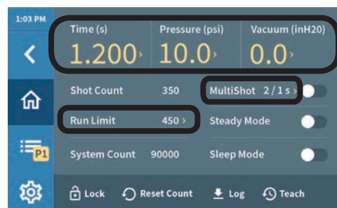
Edytowalne ustawienia na ekranie głównym: czas, ciśnienie, podciśnienie, limit cykli i MultiShot
