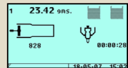
Ekran operacyjny wyświetla bieżącą dawkę, dostępność materiału i wskaźniki gotowości pompy
